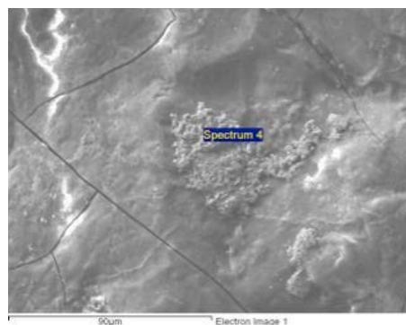
Figura 5.43: spettro EDS e relativa immagine della zona di indagine (moneta 8).
